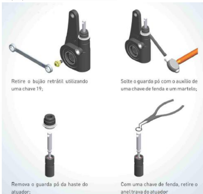
Figura 14 - Instruções de Manutenção (Ajustador Automático de Freio)
