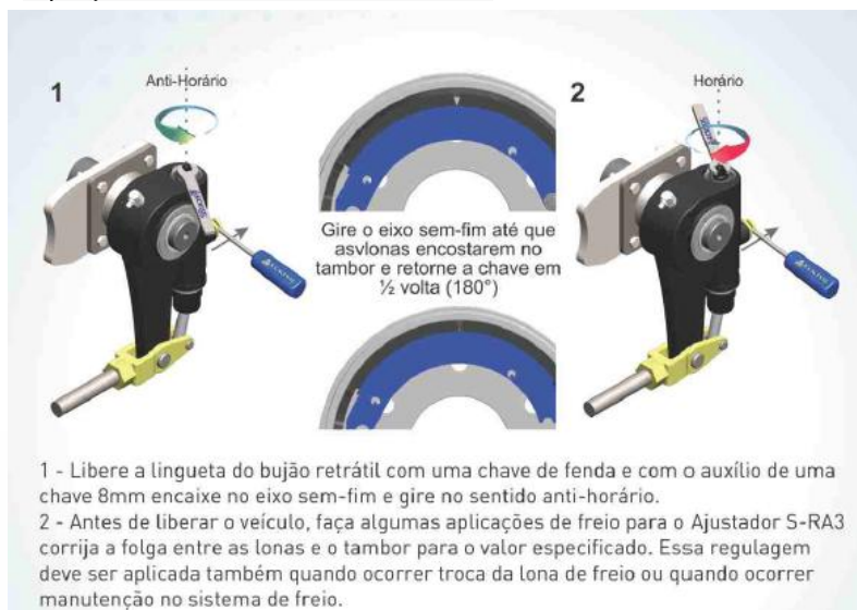
Figura 16 - Instruções de Manutenção (Regulagem catraca automática)
