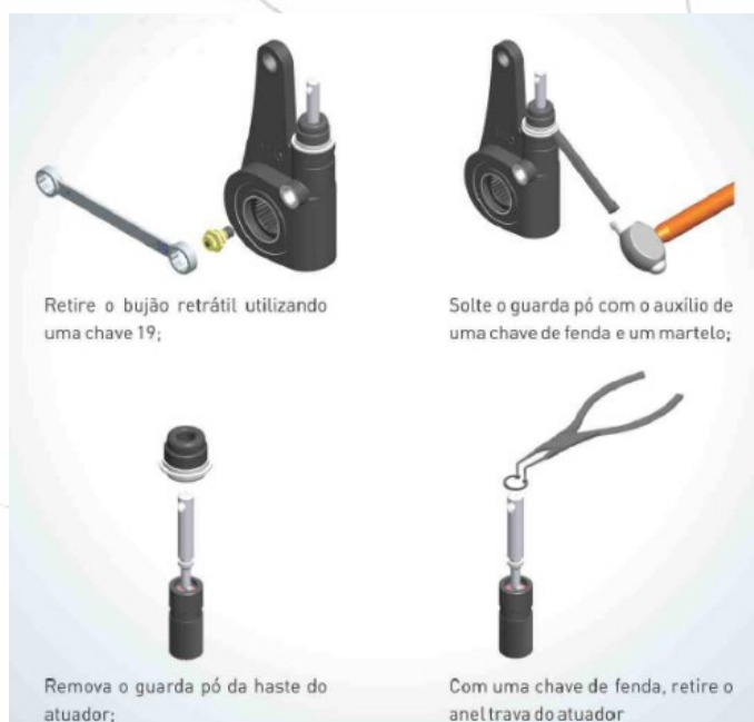
Figura 26 - Instruções de Manutenção (Ajustador Automático de Freio)
