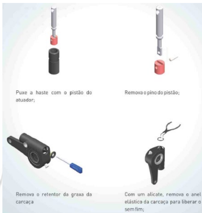
Figura 25 – Instruções de Manutenção (Ajustador Automático de Freio)
