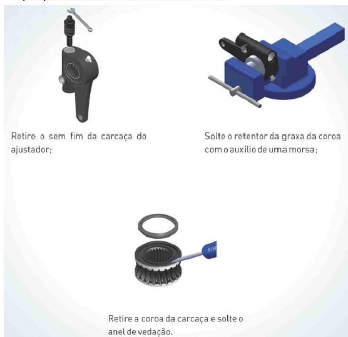
Figura 27 - Instruções de Manutenção (Ajustador Automático)
