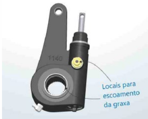
Figura 23 - Locais para escoamento de graxa
